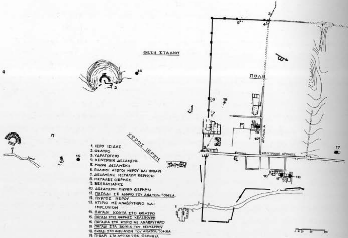
Σχ. 1. Τοπογραφικό διάγραμμα Δίου, στο οποίο σημειώνονται οι θέσεις των πηγαδιών και των σημαντικότερων κατασκευών που σχετίζονται με υδραυλικά.
