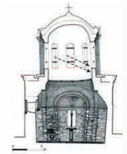
Εικ. 6: Τομή κατά πλάτος, σχηματική απεικόνιση των ακτίνων του ήλιου με κατεύθυνση τη νότια πλευρά του τυμπάνου του τρούλλου.
